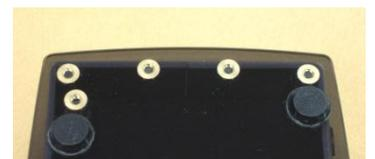
・外装部品を取り付けるボルトには、精密感のある六角穴付き皿ネジを8本使用。更にはボトムカバーに真鍮製のインサートナットを圧入し、振動による音質劣化や経年変化によるネジ緩みをシャットアウト。
